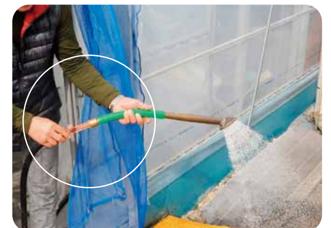
水に酸素を取り込む装置
